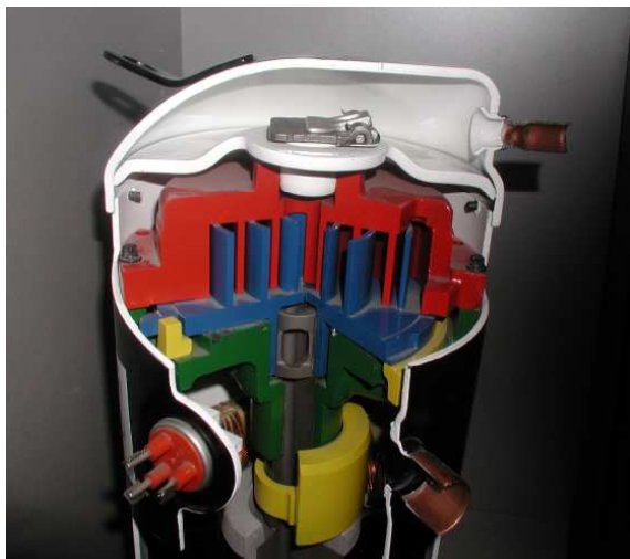
Bild 1+2: Scroll-Bauweise und Verdichterprinzip
